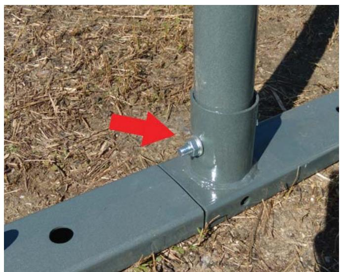
出入口のアーチが完成したら、ベースパイプにはめ込みます。（4箇所）ベースパイプはめ込み口（図3）にはボルト用の穴が空いていますのでパイプと差込口の穴を合わせて付属のボルトを差し込んでください。
